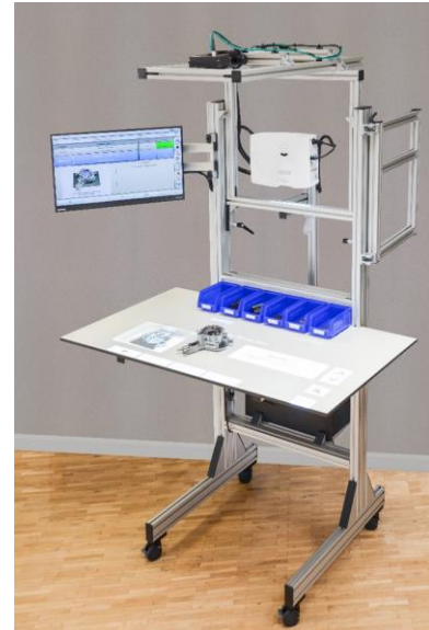
Projektion auf die Arbeitsoberfläche
