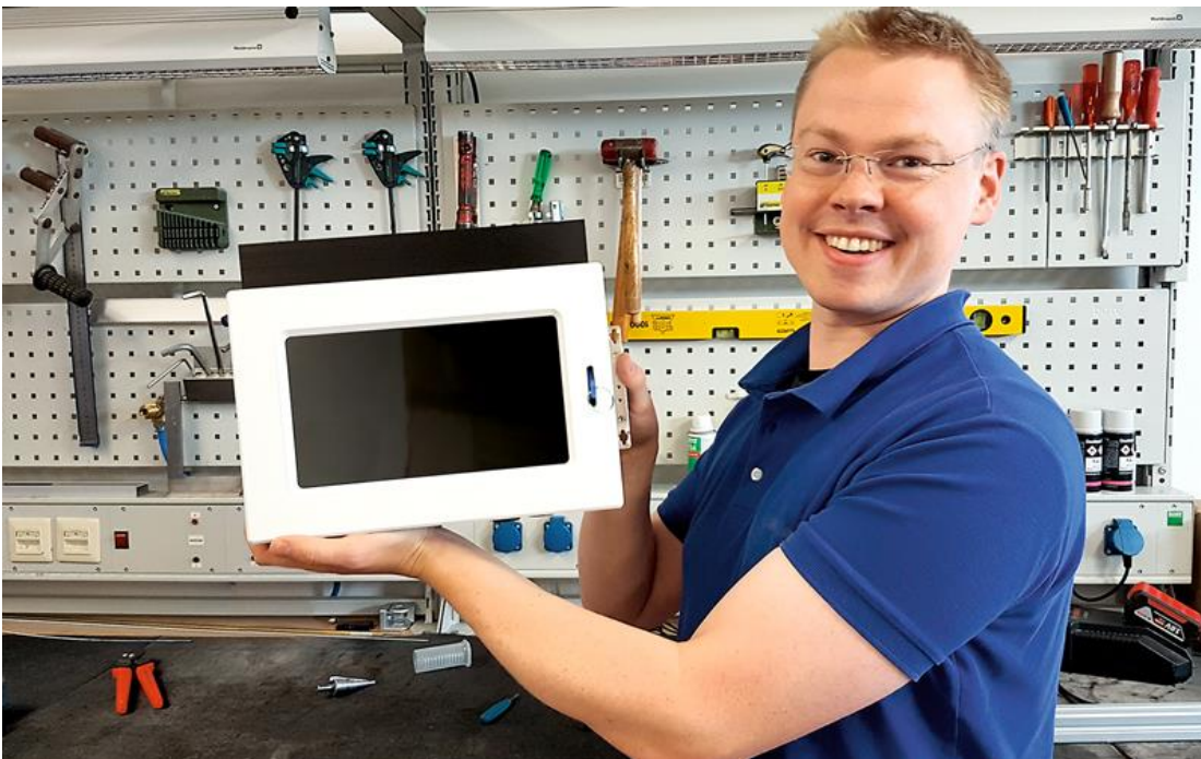
Bild 1: kompakter Arbeitsplatzrechner SWA Client 3288 von Armbruster Engineering. Weitere Bauformen sind lieferbar.
