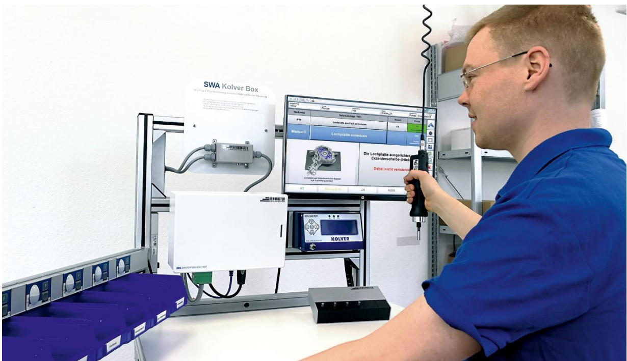
Bild 5: Anbindung von Schrauber und zusätzlichen Sensorsignalen am Schrauberadapter
