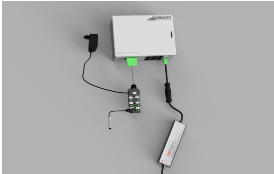
Bild 4: Signalinsel für bis zu 6 Sensoren, angebunden am SWA Client mit Netzteil
