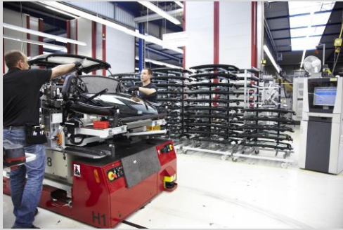
Autozulieferer nutzen EOL-Stationen zur Qualitätsabsicherung
