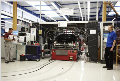
Mitarbeiter können über einen Handdatenterminal alle Daten und Prüfschritte der EOL-Station sehen und beantworten
