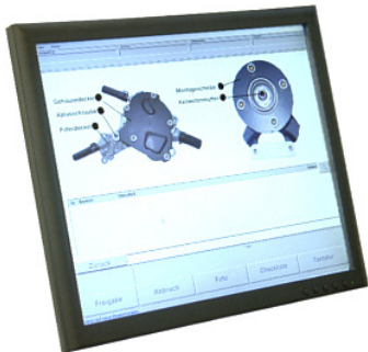
19"-Touch panel im Kunststoffgehäuse (STAMA-Artikel-Nr. 3155)
