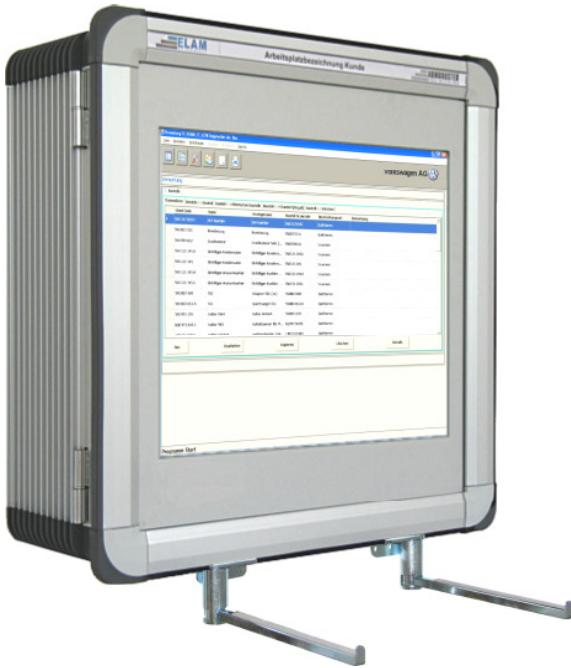
19"-TouchPanel im CP-Gehäuse mit Ablagestegen für eine Tastatur
