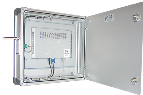
19" Touch Panel im CP-Gehäuse. Rückansicht geöffnet
