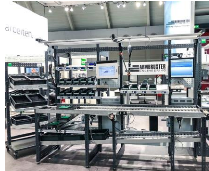
SWA im Einsatz mit Anbindung eines Monitors, Pick to Light und Sensorik über Ein- und Ausgänge
