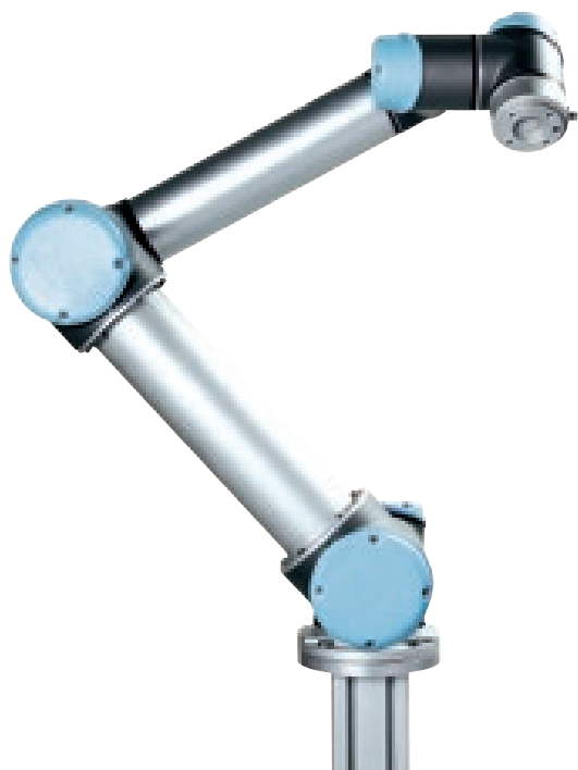
6-achsiger Gelenkroboter (STAMA Nr. 3525)
